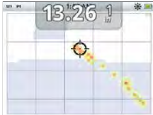
図 12 - 2つのターゲット(コインとねじ)を表示しているターゲットトレース
